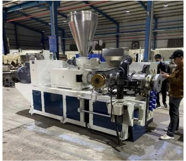
Máy ép đùn hai trục vít với bộ phận cải tiến phủ trực tiếp lớp bề mặt lên sản phẩm trong quá trình ép đùn sản phẩm do Công ty TNHH Công nghiệp Quang Nam nghiên cứu chế tạo.
