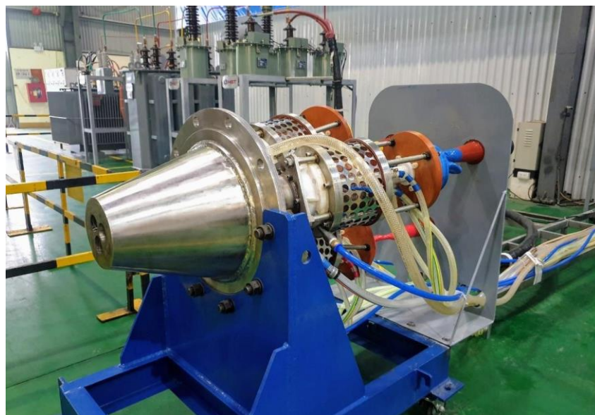
Đầu phát plasma xử lý rác y tế do các chuyên gia Viện Công nghệ VinIT phát triển. Ảnh: NVCC.
