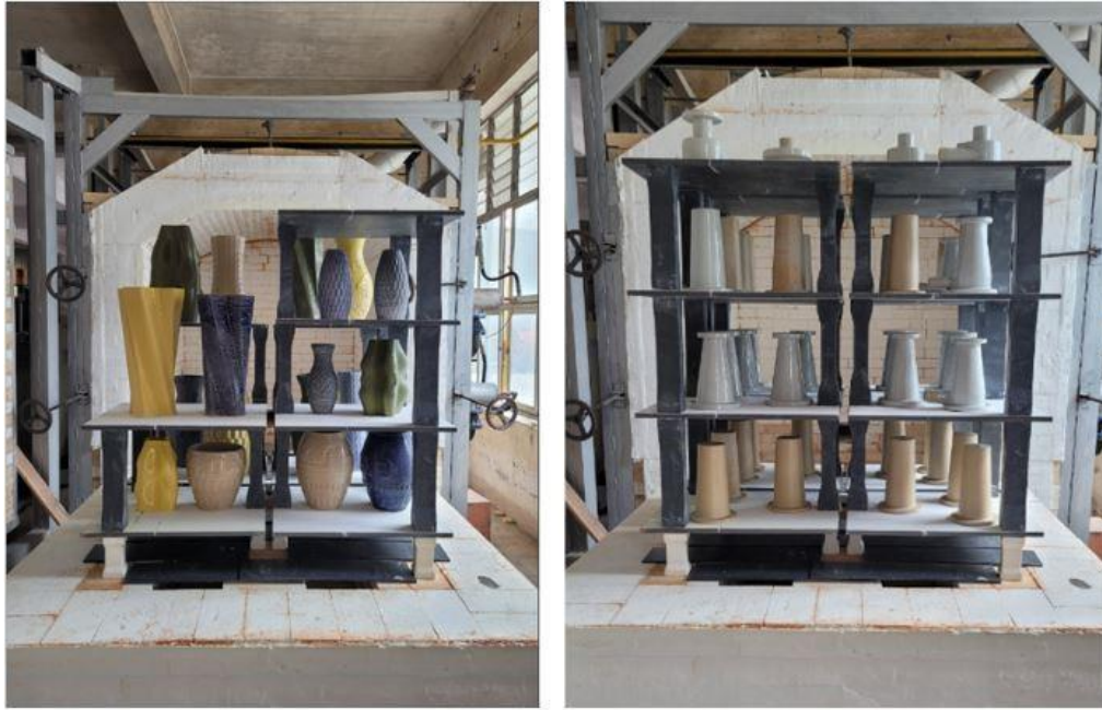
Lò nung con thoi sử dụng nhiên liệu LPG có nhiệt độ nung tới 1.500°C.
