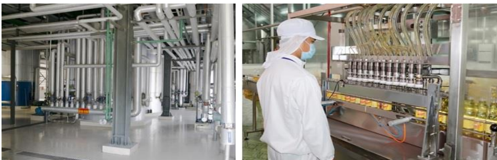
Dây chuyền công nghệ sản xuất dầu ăn từ phụ phẩm cá tra của Tập đoàn Sao Mai
