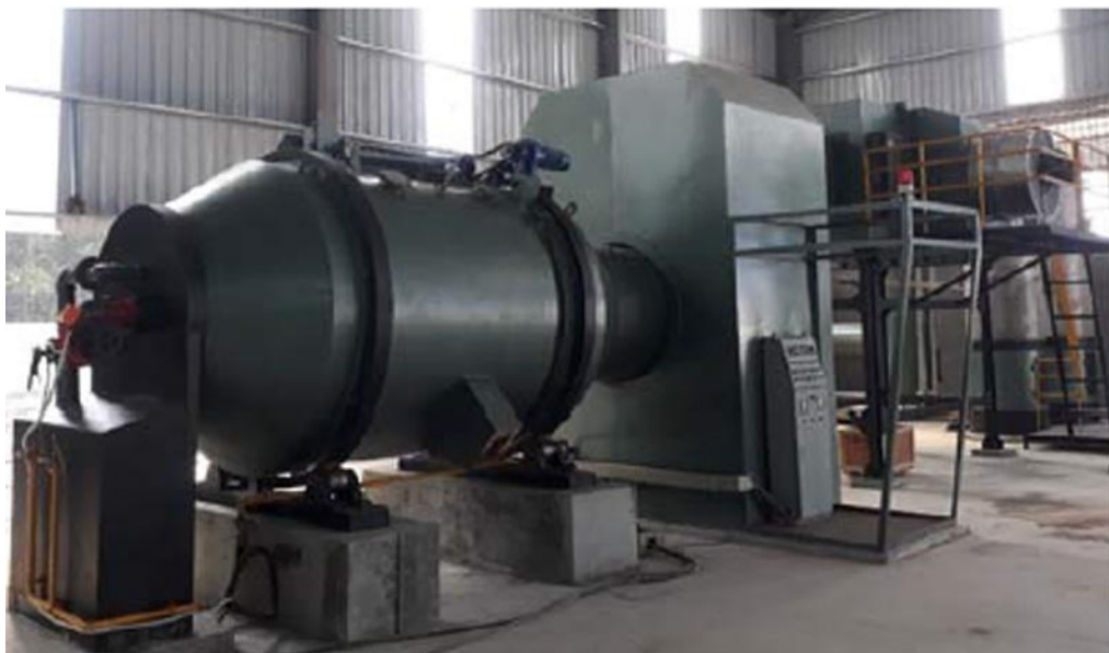
Lò đốt bản mạch và tái chế kim loại bằng hồ quang điện.
