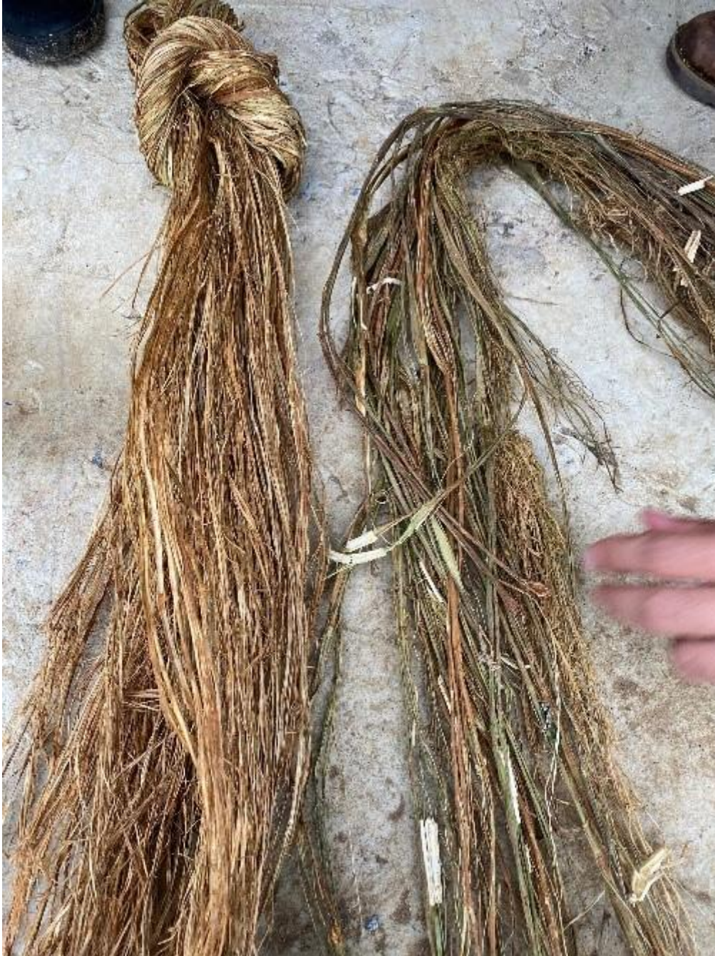
Sản phẩm của máy tuốt mới nhập khẩu nhiều lô cuốn chưa đáp ứng được chất lượng (bên phải)
