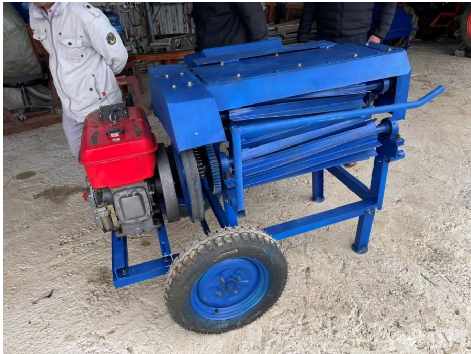
Máy tuốt gai nhập khẩu với nhiều lô cuốn hiện vẫn chưa hiệu quả
