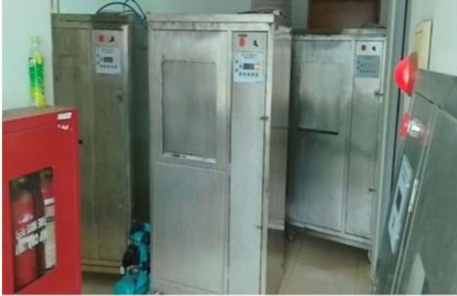
Thiết bị rửa siêu âm kết hợp dòng xoáy và sấy khô VUSH2122 do VIELINA nghiên cứu, chế tạo.
