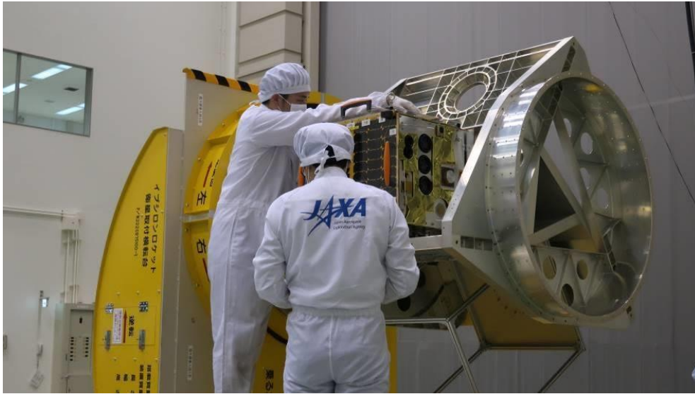
Vệ tinh MicroDragon được các kỹ sư JAXA lắp đặt để thử nghiệm trọng tâm, ảnh chụp tháng 6/2018. (Ảnh JAXA)
