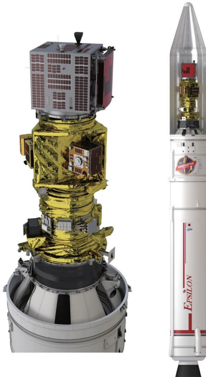
Các vệ tinh lắp đặt trong tên lửa Epsilon số 4 (Ảnh: JAXA)
