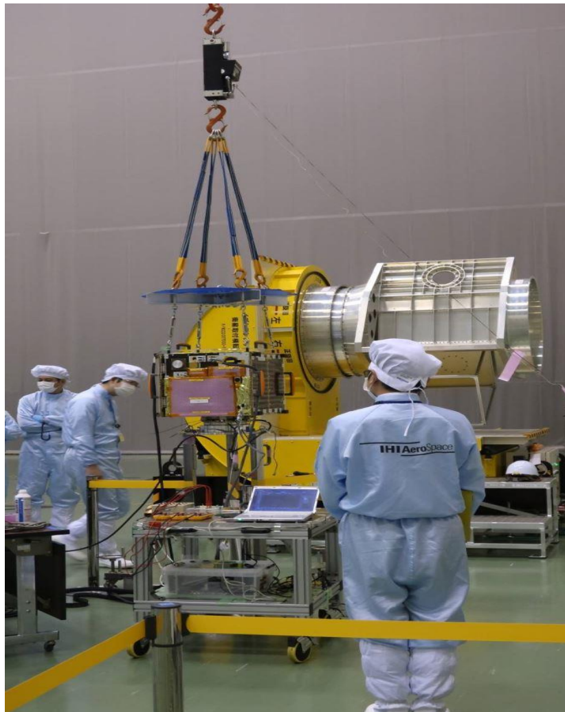
Các kỹ sư của IHI và JAXA thực hiện những kiểm tra vệ tinh MicroDragon, ảnh chụp tháng 6/2018 (Ảnh JAXA)
