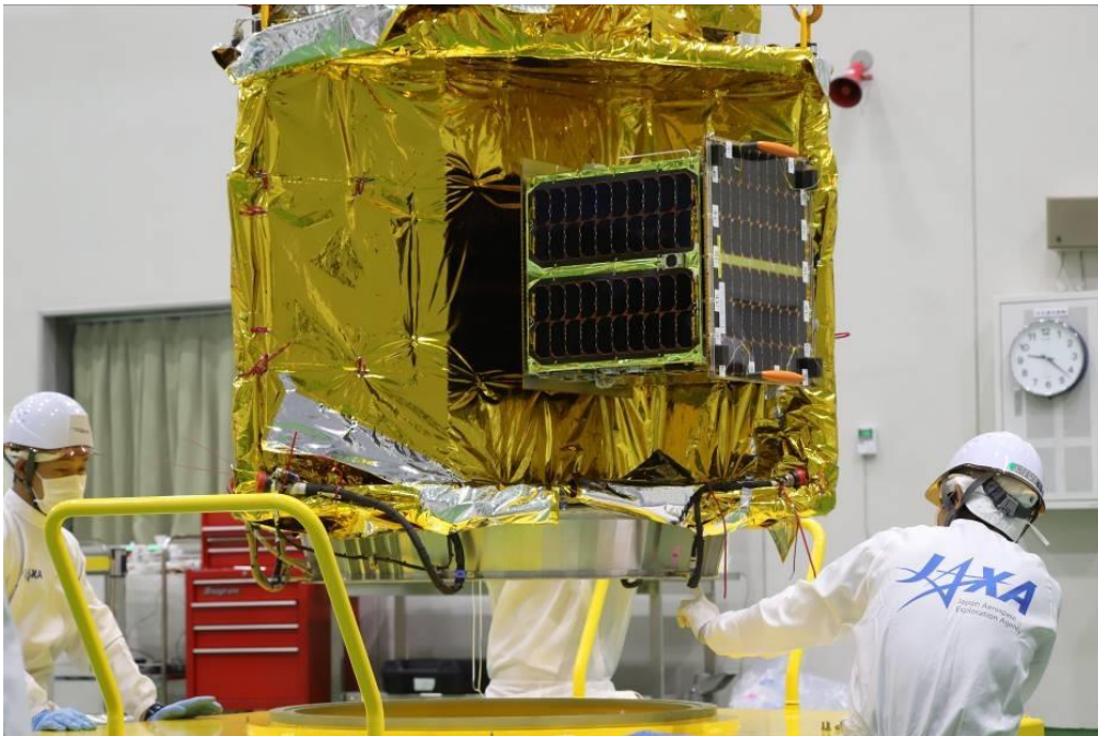
Lắp đặt vệ tinh MicroDragon vào khoang chứa vệ tinh của tên lửa đẩy Epsilon số 4, ảnh chụp tháng 8/2018. (Ảnh JAXA)
