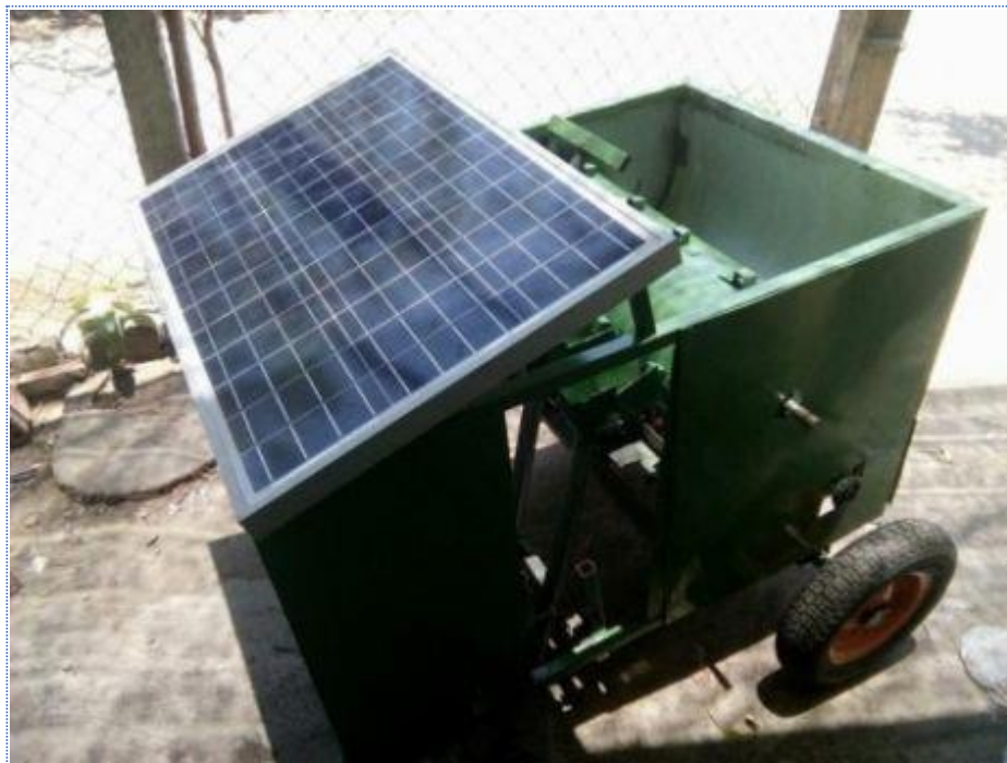
Ảnh: Máy trồng hành tím chạy bằng năng lượng mặt trời, ảnh: Thanh Hưng
