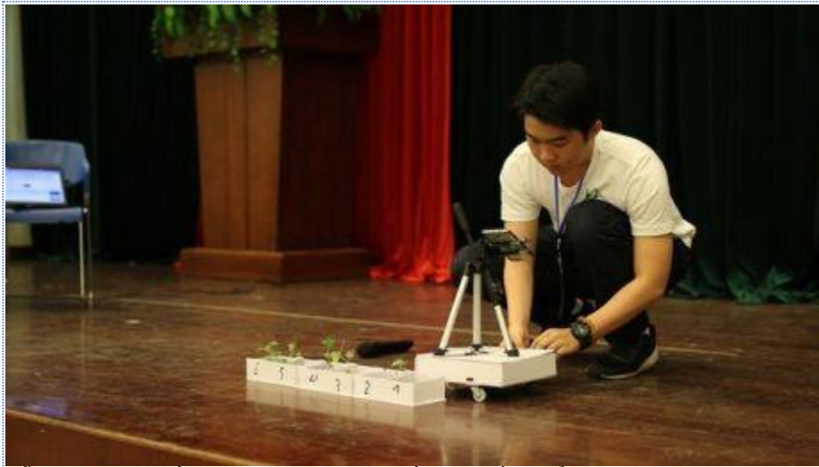
Đỗ Minh Huy tự trồng, gây bệnh trên cây trồng và điều khiển rôbot dò bệnh thử nghiệm - Ảnh: BẢO NGUYỄN
