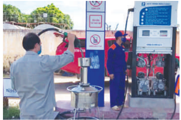
Thực hiện kiểm định cột bơm xăng dầu
