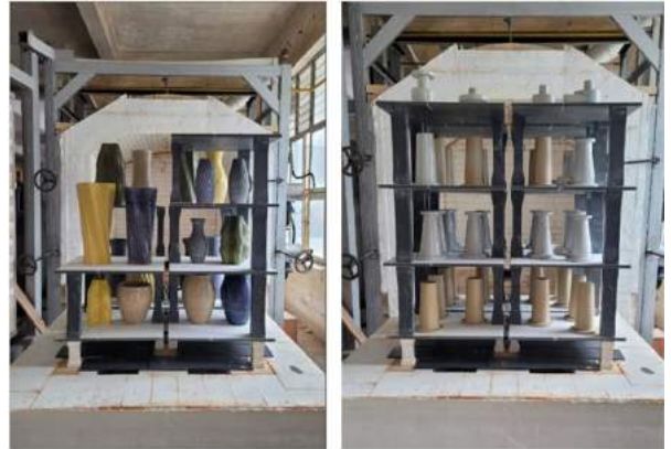
Lò nung con thoi sử dụng nhiên liệu LPG có nhiệt độ nung tới 1.500°C.
