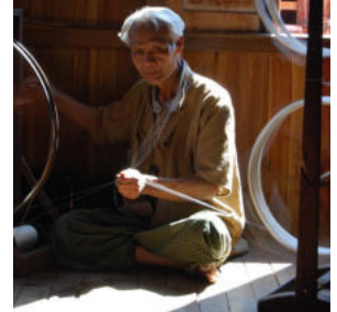
Ươm tở là việc kéo sợi từ kén tằm thành sợi tở lụa để dệt thành vải
