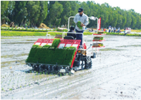
Ứng dụng máy cấy lúa phục vụ sản xuất lúa giống ở Thọ Sơn
