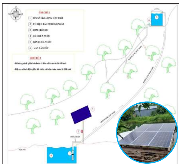
Mô hình trồng xoài diện tích 01 ha lắp đặt hệ thống bơm nước sử dụng điện năng lượng mặt trời điều khiển bằng smartphone của nông hộ Ông Bùi Văn Quý
