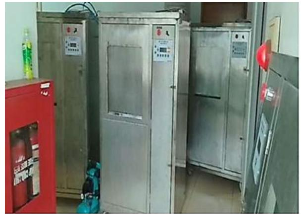
Thiết bị rửa siêu âm kết hợp dòng xoáy và sấy khô VUSH2122 do VIELINA nghiên cứu, chế tạo
