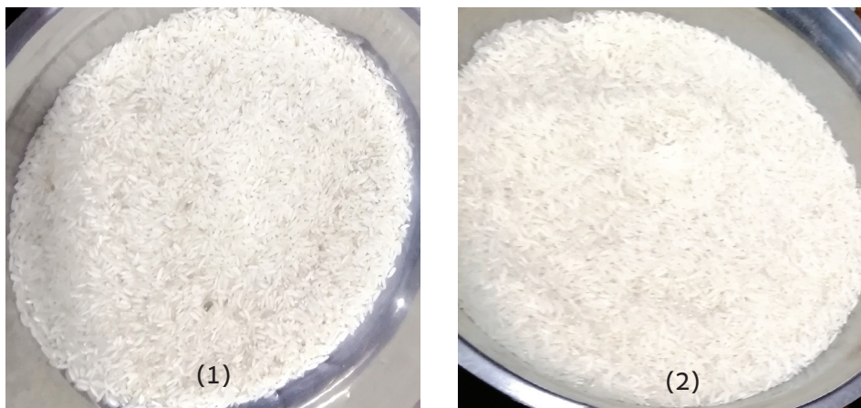
Hình 2. (1) gạo trước khi xử lý qua máy tách màu, (2) gạo sau khi xử lý qua máy tách màu
