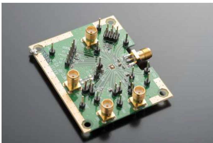
Vi mạch thu phát không dây do Đại học Bách khoa Hà Nội nghiên cứu thiết kế.
