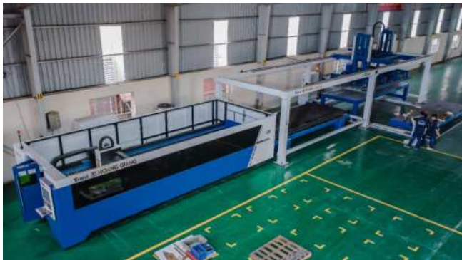
Dây chuyền cắt CNC laser Yawei FMC với bộ cấp phôi tự động kích thước lớn đầu tiên tại Việt Nam.
